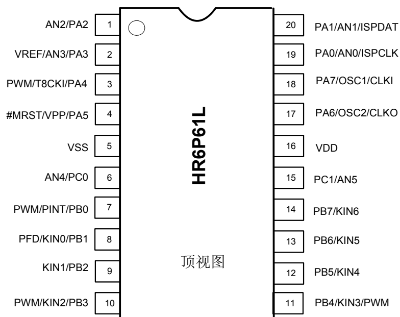
图 1-2 HR6P61L (DIP20/SOP20/SSOP20) 顶视图
