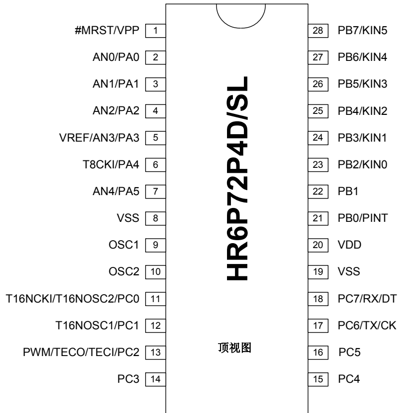
图 1-2 HR6P72L (SKDIP28/SOP28) 顶视图
