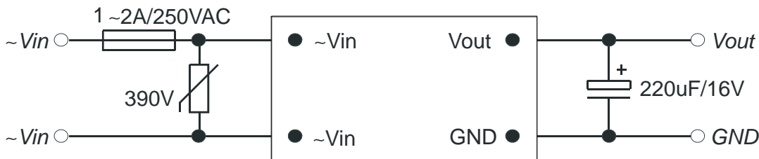
图 1-3 PS1000AC5SR 和 PS0300AC12SR 电源应用电路
