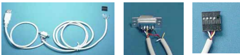
图 7 USB 连接电缆实物连接
