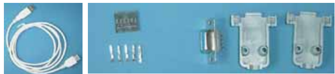
图 5 自制 USB 连接电缆所需材料
